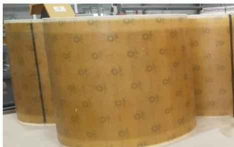
*Láminas de ECTFE que incluyen un elemento conductor en la zona de soldadura*
