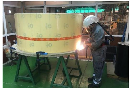
*Soldadura con gas caliente de chapas con soporte textil de ECTFE*
