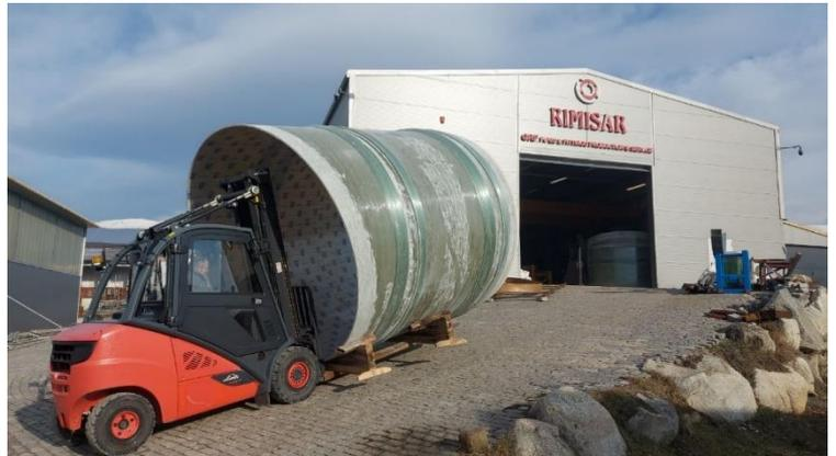
*Chimenea de 140 m de altura y 3200 mm de diámetro.*
