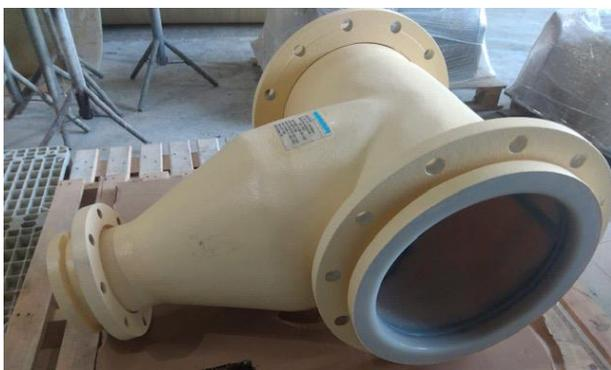
Pieza fabricada con láminas de FEP y recubierta de fibra de vidrio
