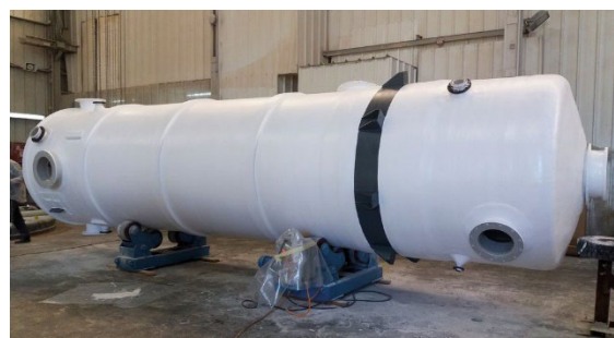
La solución AGRU ECTFE de doble lámina para BEL Technologies Ltd.
