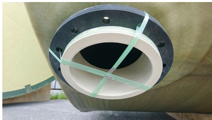
Las conexiones del tanque se realizaron con accesorios AGRU PP.
