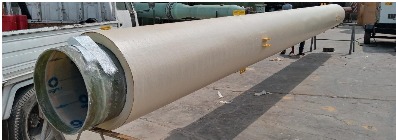
Processo de laminação da chaminé com ECTFE SK+
