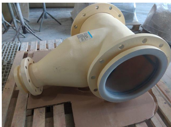
Peça produzida com chapas de FEP e revestida com fibra de vidro
