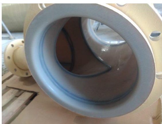
Peça produzida com chapas de FEP e revestida com fibra de vidro
