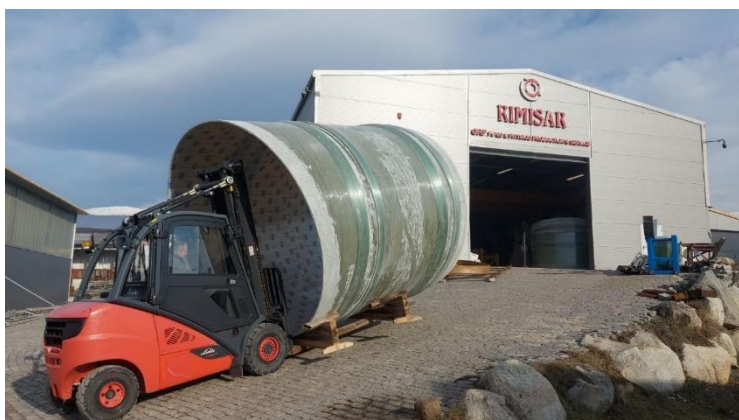
Chaminé de 140 metros de altura e 3200mm de diâmetro.
