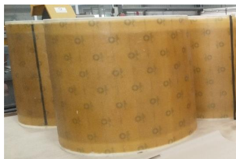
Chapas de ECTFE que incluem um elemento condutor na zona de solda
